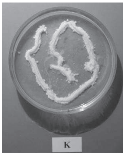
Ryc. 3. Cement K zarabiany wodnym roztworem bursztynianu sodu (12% wag.)
