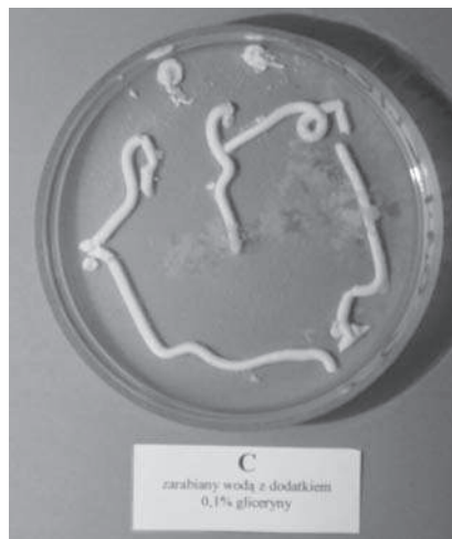
Ryc. 6. Cement C zarabiany roztworem gliceryny (0,1% wag.)
