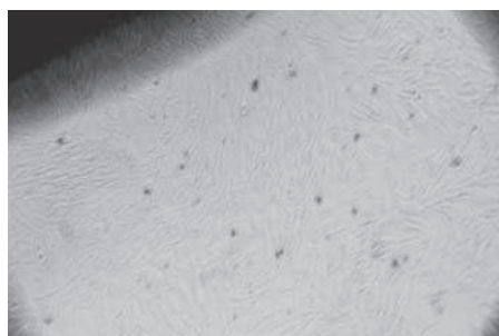
Ryc. 13. Hodowla fibroblastów mysich 3T3 Balb/C po 48-godzinnym kontakcie z cementem C w bezpośrednim kontakcie z próbką; widoczne drobiny cementu
