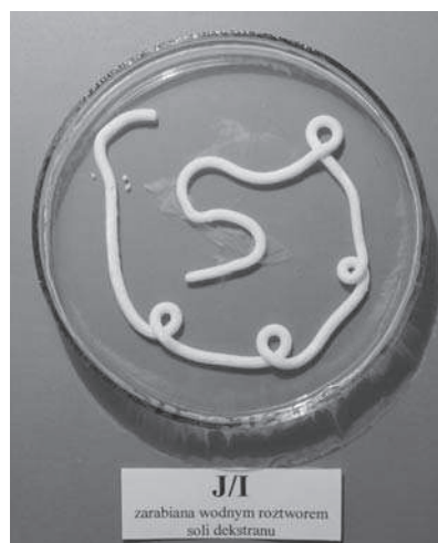
Ryc. 8. Cement J/I zarabiany wodnym roztworem soli dekstranu (2,5% wag.)
