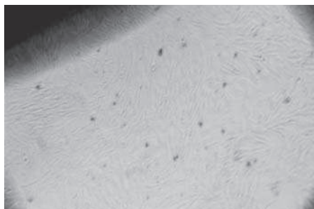
Ryc. 15. Hodowla fibroblastów mysich 3T3 Balb/C po 48-godzinnym kontakcie z cementem C-0,1 gl. w bezpośrednim kontakcie z próbką
