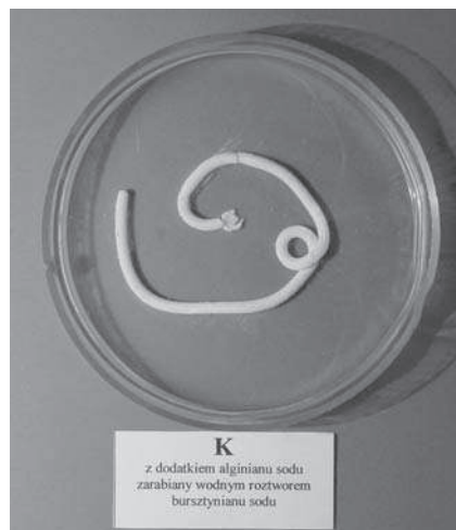
Ryc. 4. Cement K z dodatkiem alginianu sodu (0,25% wag.) zarabiany wodnym roztworem bursztynianu sodu (12% wag.)
