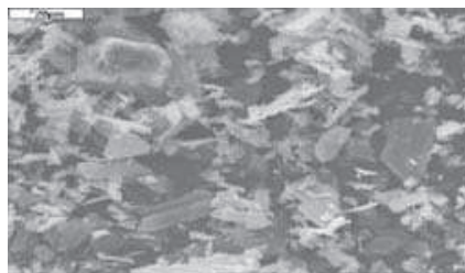
Ryc. 7. Gips chemiczny otrzymany w roztworze kwasu siarkowego; powiększenie x500
