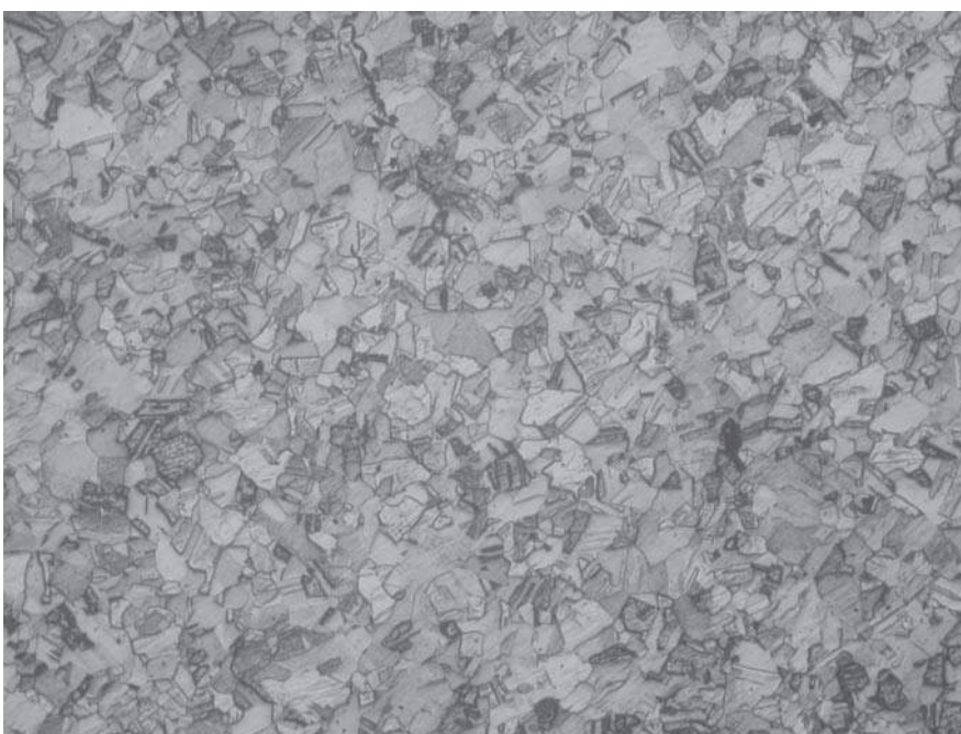
Ryc. 5. Mikrostruktura taśmy z mosiądzu M70 wyżarzanej w dolnej strefie starego pieca kołpakowego
