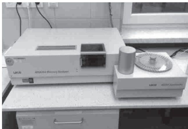
Ryc. 1. Analizator rtęci AMA 254 wraz z automatycznym podajnikiem prób AS 254
