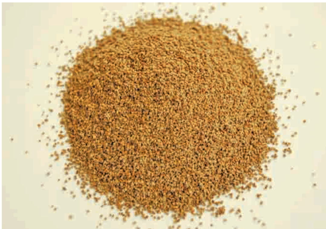
Ryc. 4. Materiał podsadzkowy (propant) oznaczony symbolem P10 po wypaleniu
