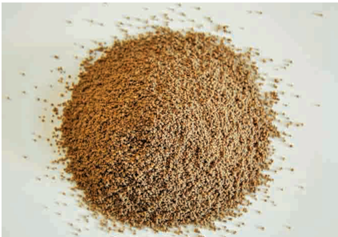
Rys. 3. Materiał podsadzkowy (propant) oznaczony symbolem P9 po wypaleniu
