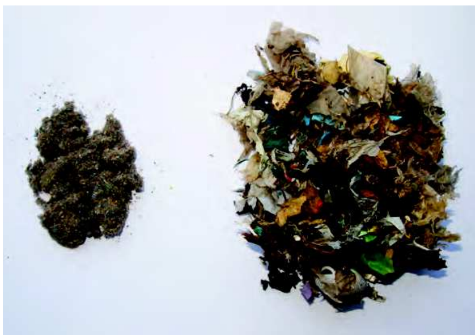
Ryc. 3. Stałe paliwo wtórne – próbka analityczna i laboratoryjna
