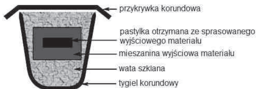
Ryc. 4. Schemat tygla z próbką użytego do otrzymania \text{YBa}_2\text{Cu}_3\text{O}_{7-x} za pomocą kucharki mikrofalowej [46]
