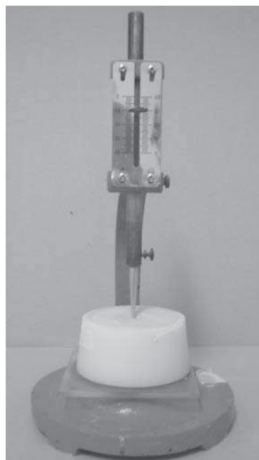
Ryc. 2. Oznaczanie czasu wiązania mas szpachlowych za pomocą aparatu Vicata
