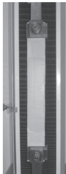
Ryc. 5. Przykład oznaczenia wytrzymałości złącza płyt metodą rozciągania
