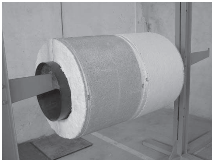
Ryc. 9. Model izolacji rurociągu otulinami NOVOSIL
