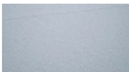
e) klej cementowy z dodatkiem reduktora o granulacji poniżej 0,05 mm
