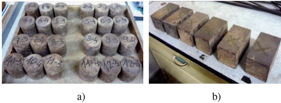
Źródło: Opracowanie własne. Ryc. 1. Próbkki do badania odporności na wstrząsy cieplne: a) walce \varnothing = h = 50 mm, b) prostopadłościany 64 mm x 64 mm x 114 mm
