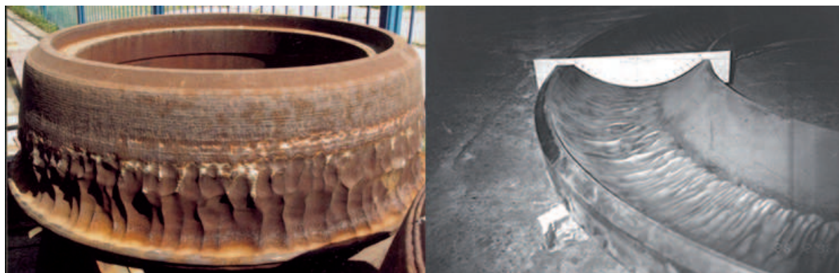
Ryc. 2. Zużyte elementy mielące: a) rolka, b) misa [14]
